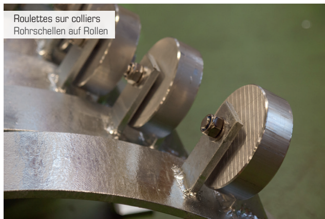
Collier pour mise en place d'une conduite d'eau en poussant dans un canal technique sans accès / Rohrschelle mit Rollen zur Verlegung von einer Wasserleitung in einem engem technischen Kanal.
