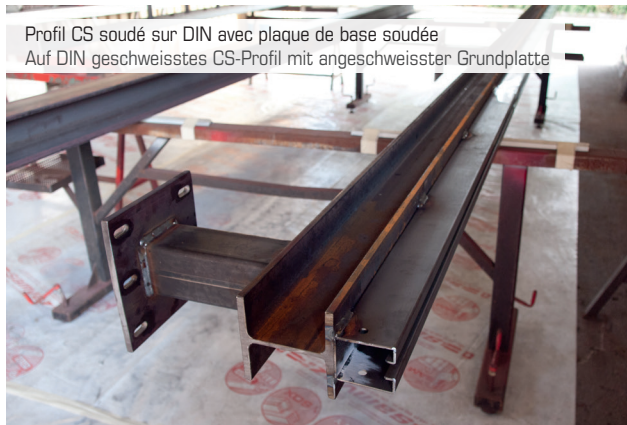
Support et collier soudé sur DIN pour barrage Rohrschelle auf geschweisstem DIN-Profil für Staudamm
